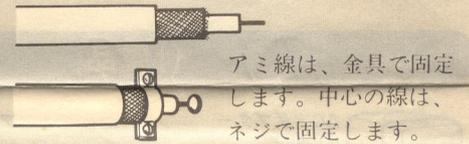
アミ線は、金具で固定します。中心の線は、ネジで固定します。
