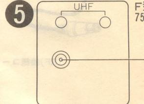
F型ジャックを使用しているテレビの場合は、現在ついているF型ジャックを分解してスイッチボックスに取り付けます。作業が大変な場合は、次の方法をお使いください。
